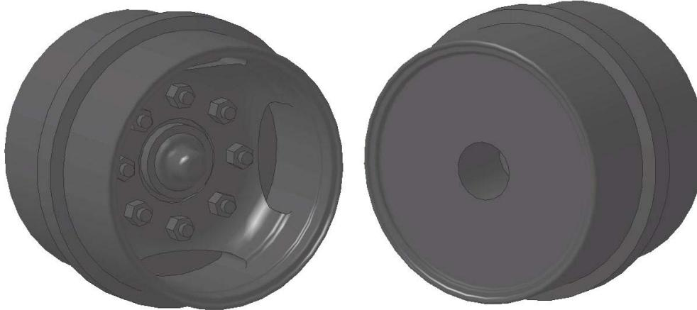
Die Felgen haben mittig einen Anschlagring für die Reifen. Daher erst die Reifen montieren und dann das komplette Rad am Fahrgestell.
